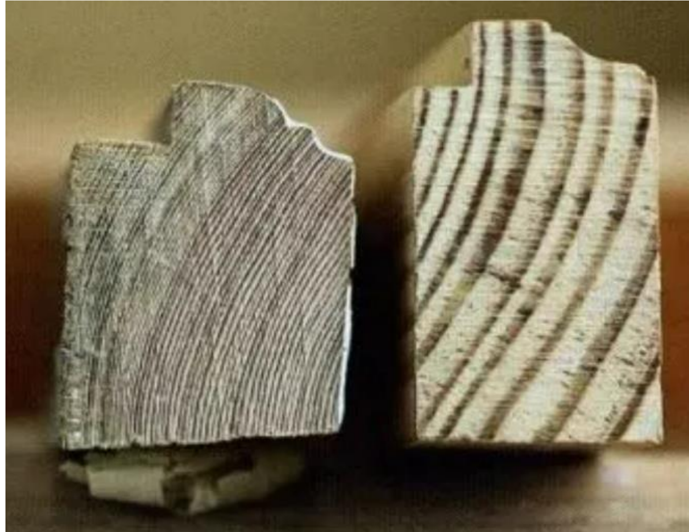
Vasemmalla vanhan, oikealla uuden ikkunapuun vuosikasvua.
